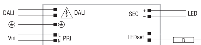
DALI diagram - Collegamento DALI
